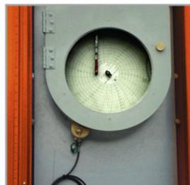
Schreibgerät für Zugkraftmessgerät
